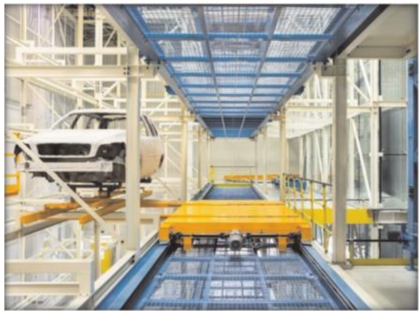
图4 多层 RGV 穿梭车立库
